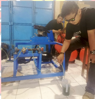
Gambar 4.3 Pengukuran debit bahan bakar sebelum mencapai karburator
