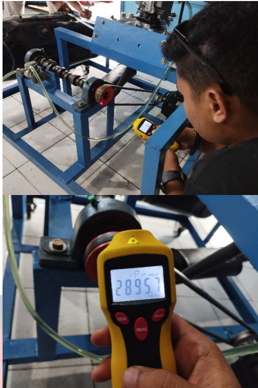
Gambar 5.12 Pengukuran putaran dan hasil pengukuran Camshaft
