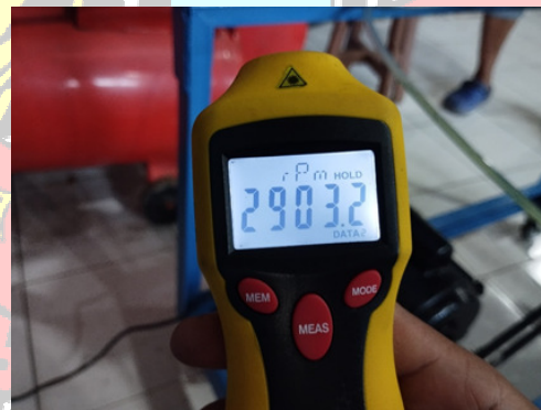
Gambar 5.11 Pengukuran putaran dan hasil pengukuran motor penggerak
