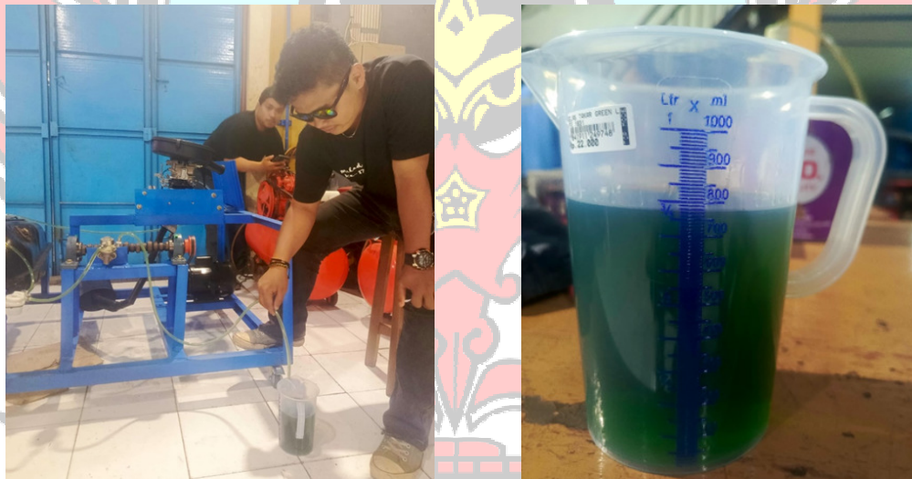
Gambar 5.9 Pengukuran debit bahan bakar dan hasil pengukuran sebelum mencapai karburator
