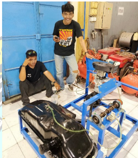
Gambar 4.4 Pengukuran debit bahan bakar setelah melewati karburator
