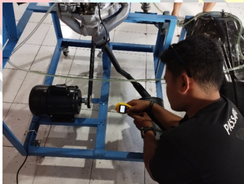
Gambar 5.11 Pengukuran putaran dan hasil pengukuran motor penggerak
