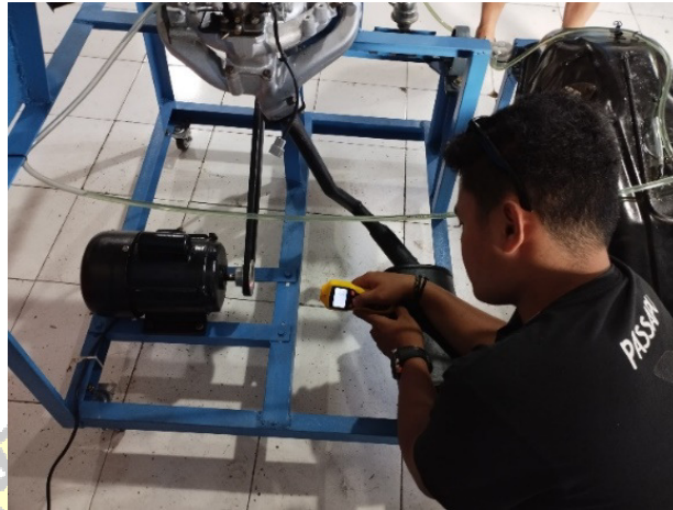
Gambar 4.5 Mengukur putaran motor penggerak
