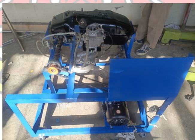
Gambar 3.4 Pemasangan Komponen Sistem Bahan Bakar
