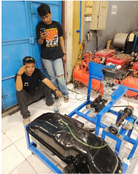
Gambar 5.10 Pengukuran debit bahan bakar dan hasil pengukuran setelah melewati tangki
