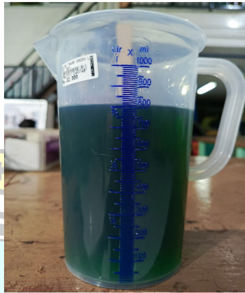
Gambar 5.10 Pengukuran debit bahan bakar dan hasil pengukuran setelah melewati tangki
