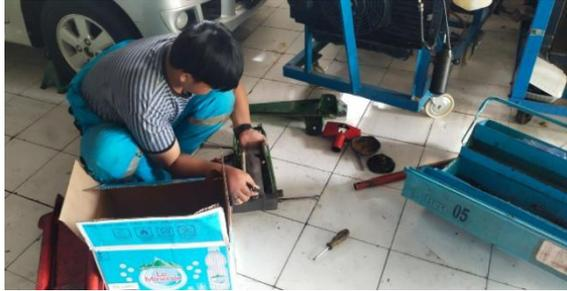
Gambar 4. 4 Pembongkaran dongkrak hidrolik B
