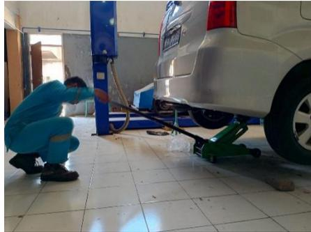
Gambar 4. 8 Menaikkan dongkrak hidrolik B
