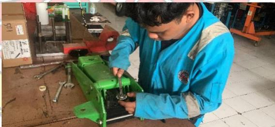
Gambar 4. 5 Pembongkaran dongkrak hidrolik C
