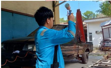
Pengecatan dongkrak hidrolis A
