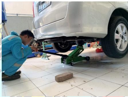
Gambar 4. 9 Menaikkan dongkrak hidrolik C
