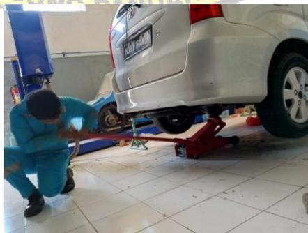
Gambar 4. 7 Menaikkan dongkrak hidrolik A
