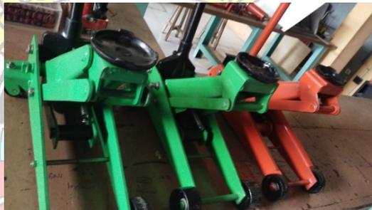
Gambar 4. 1 Kondisi 3 unit dongkrak hidrolik setelah perbaikan
