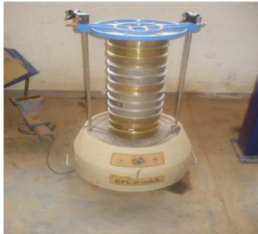
Saringan yang digunakan untuk pembagian butir (gradasi) tanah
