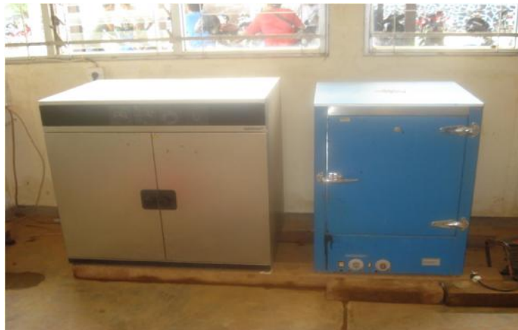
Oven yang digunakan untuk menentukan kadar air yang terkandung dalam tanah
