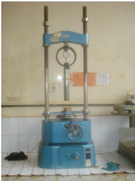
Alat Unconfined Test untuk menentukan kekuatan geser tanah
