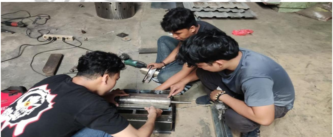
Proses pemasangan poros penyosoh dan mengukur jarak antara poros dengan pis
