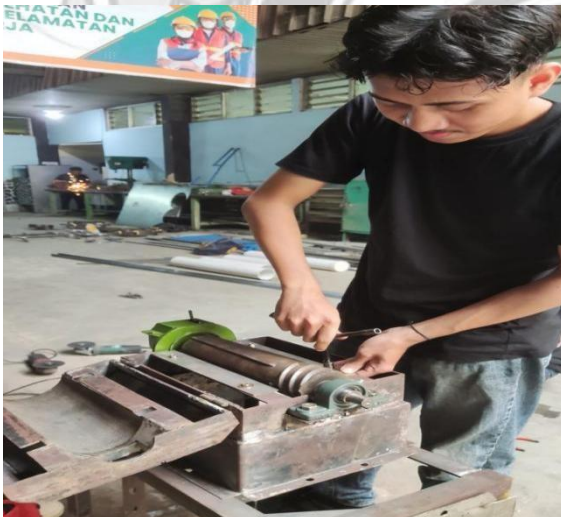
Proses pemasangan poros penyosoh dan mengukur jarak antara poros dengan pis
