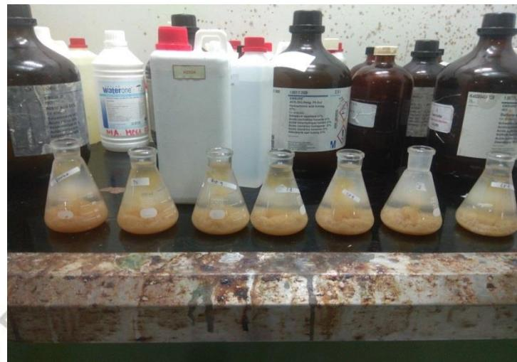
Foto Proses Penambahan MnSO<sub>4</sub> dan Alkali Iodida Azida pada Pengujian BOD
