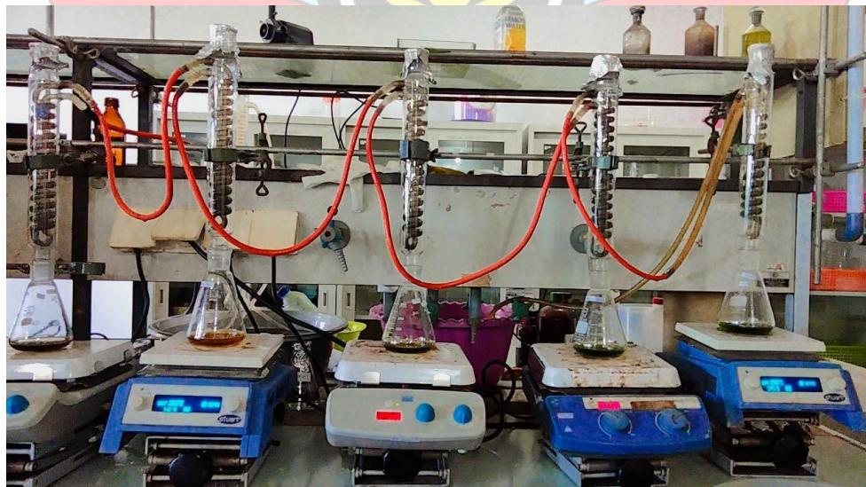
Foto Proses Refluks pada Pengujian COD
