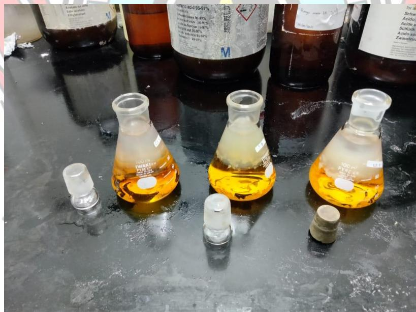
Foto Proses penambahan H<sub>2</sub>SO<sub>4</sub> pada Pengujian BOD
