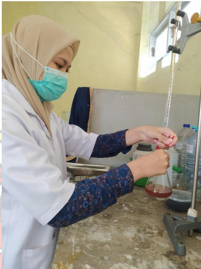
Foto Proses Titrasi pada Pengujian COD
