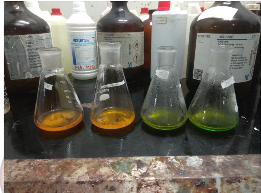
Foto Proses Penambahan Larutan Perekasi  $H_2SO_4$  pada Pengujian COD
