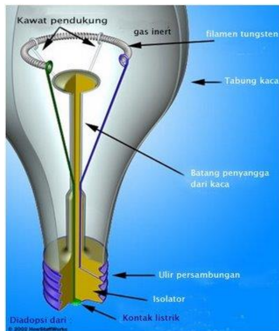
Gambar 1. Konstruksi Lampu Pijar
