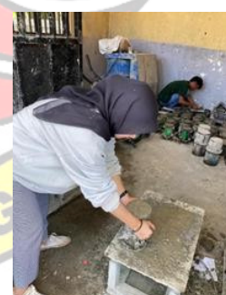
Menggetarkan cetakan yang berisi campuran untuk menghilangkan udara yang terdapat di dalamnya
