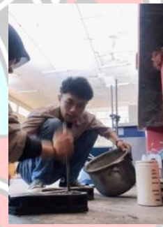
Memasukkan Mortar pada Cetakan
