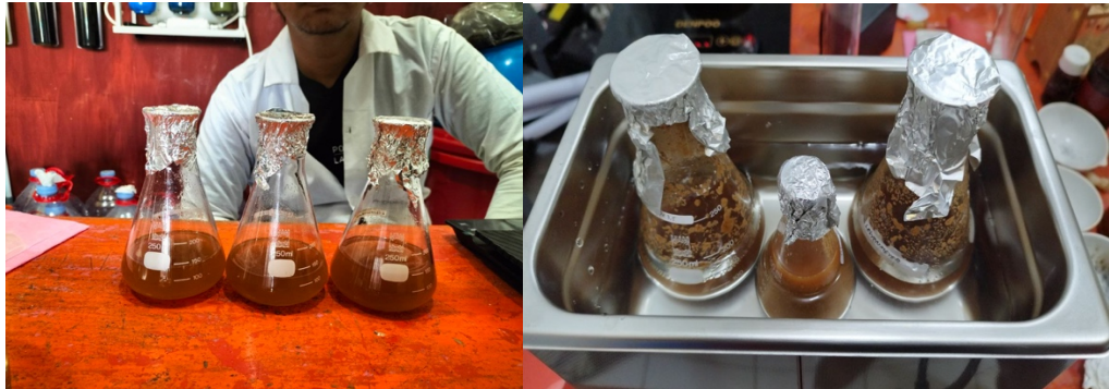
Gambar 5. Larutan Edible Coating Pra Estraksi dan Ekstraksi dengan Ultrasonik Bath ( Ultrasonic Assisted Solvent Extraction )
