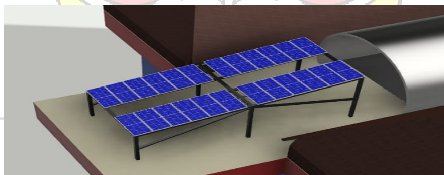
Gambar 5.6 Desain Layout PLTS Hybrid Gedung AD PNUP Tampak Dekat
