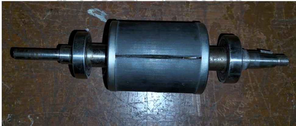
Gambar 4. 3 Hasil Pengadaan Konstruksi Rotor Generator dengan Menggunakan Magnet Ferrit . A) Rotor 2 Kutub; B) Rotor 4 Kutub
