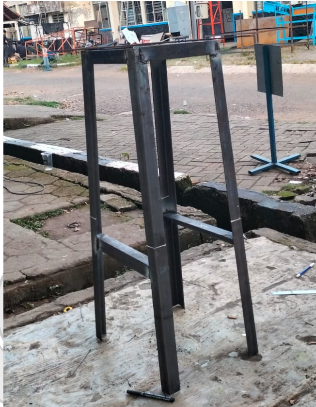
Gambar 4. 5 Hasil Konstruksi Dudukan Generator
