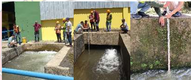
Gambar 5.16 Pengukuran Tailrace Turbin 2,5 MW Dan 0.5 MW Menggunakan Current Meter & Rambu Ukur
