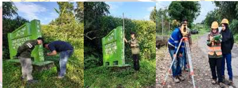
Gambar 5.24 Penentuan Titik Acuan Bada tinggi MDPL Menggunakan Apps My Elevation & Pengukuran Bada Tinggi Menggunakan Alat Ukur Theodolite
