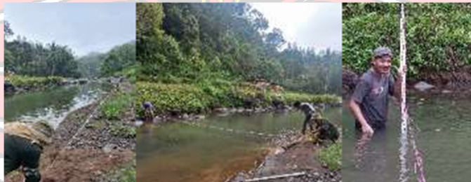
Gambar 5.21 Pengukuran Panjang, Lebar, Dan Kedalam Reservoir Alami Menggunakan Roll Meter & Rambu Ukur
