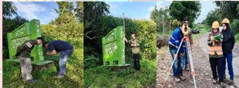
Gambar 5.20 Penentuan Titik Acuan Bada tinggi MDPL Menggunakan Apps My Elevation & Pengukuran Bada Tinggi Menggunakan Alat Ukur Theodolite
