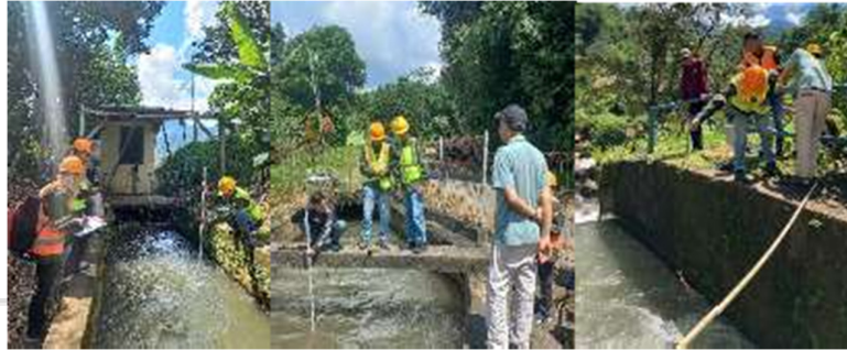
Gambar 5.19 Pengukuran Saluran Waterway , Saluran Masuk Headpond , Tailrace Menggunakan Current Meter & Rambu Ukur
