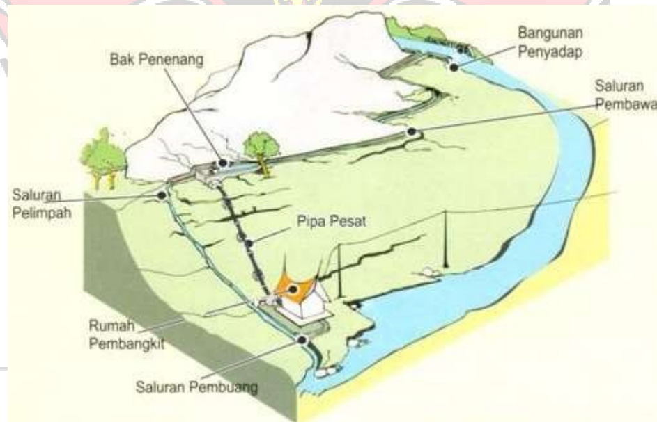
Gambar 2.2 Bagian - bagian PLTMH Sumber : (Yayasan Tunas Cendekia, 2023)
