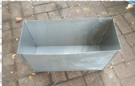
Gambar 4.4 Bak Penampung Air Inlet
