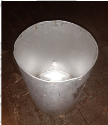
Gambar 4.2 Rumah Turbin (casing)
