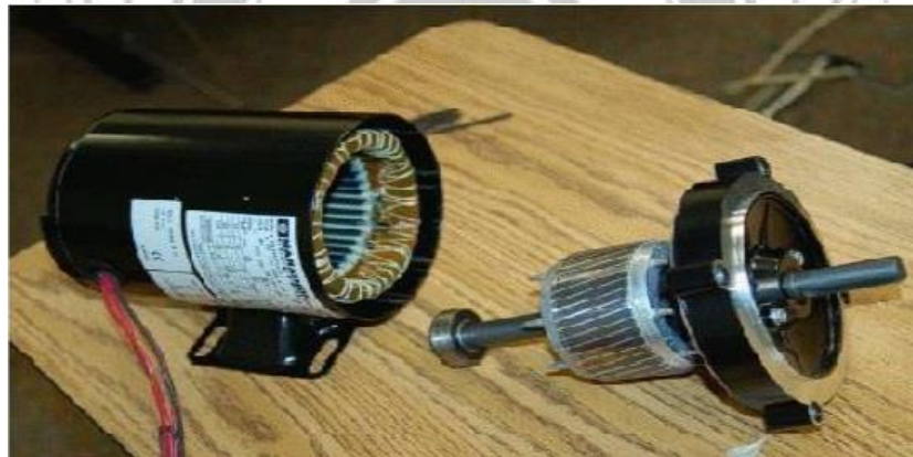
Gambar 2.9 Rotor Sangkar Tupai
