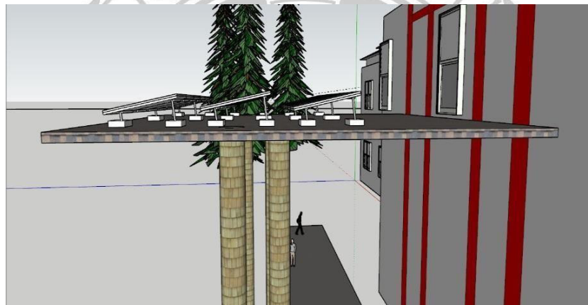
Gambar 4.61 Desain Layout PLTS Sisi Rooftop Tampak Samping
