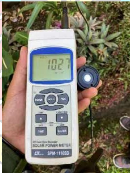
Hasil pengukuran radiasi matahari menggunakan Solar Power
