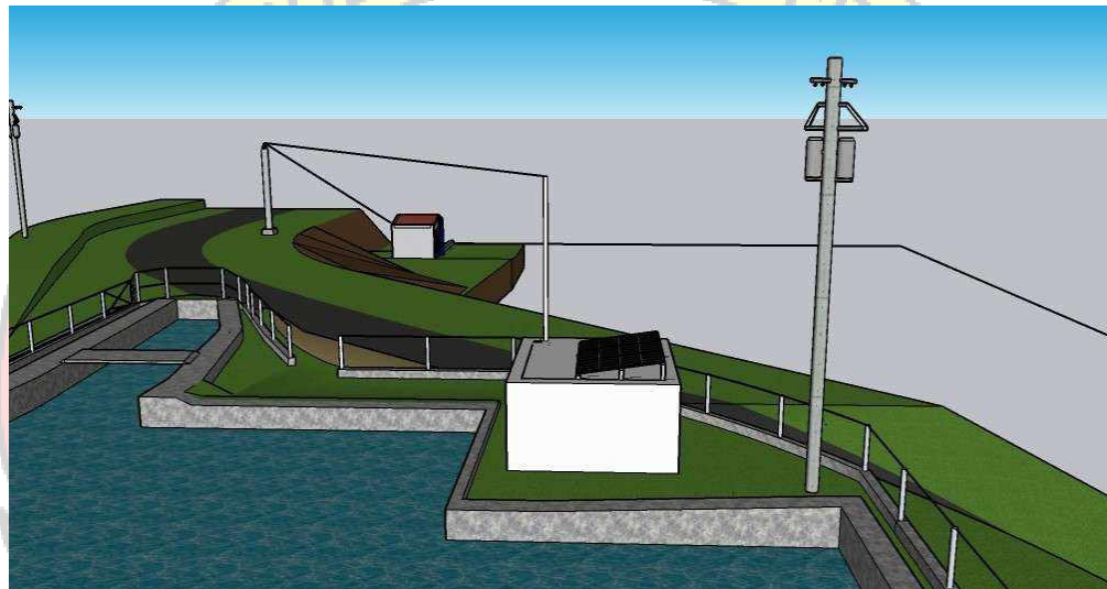
Gambar 5. 2 Ilustrasi Penempatan Panel Surya di headpone PLTMH Tombolo Pao
