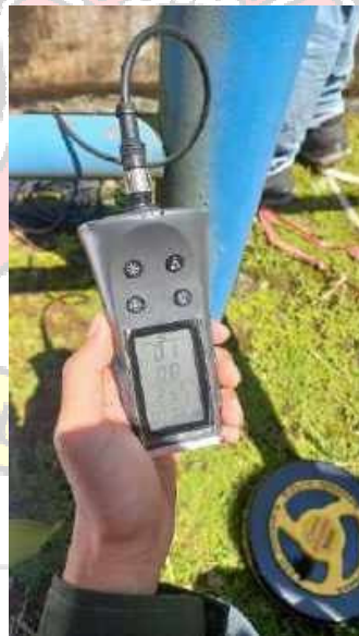
Hasil pengukuran kecepatan air menggunakan current meter
