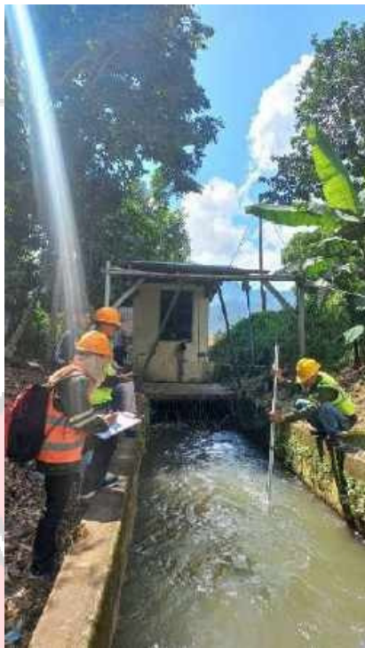
pengukuran kecepatan air pada water way (sebelum trash rack)
