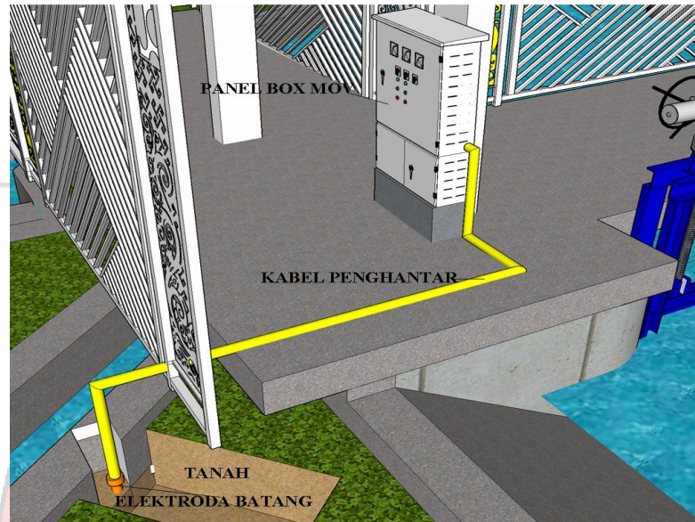
Gambar 4. 10 Grounding System (Pembumian) pada PLTS Eksisting
