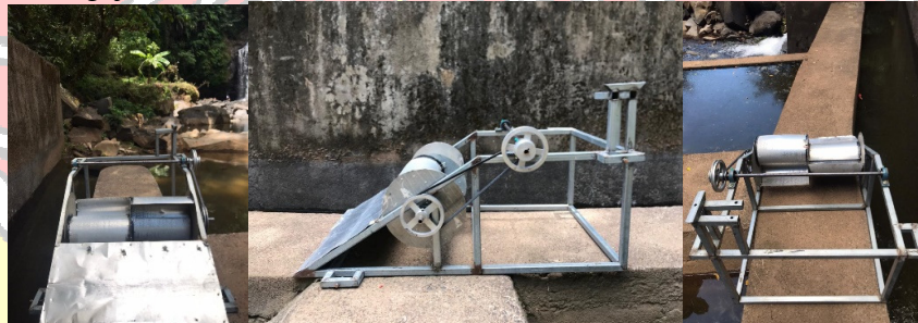
Gambar 8. hasil konstruksi untuk rotor savonius bawah air seri dengan sumbu horizontal
