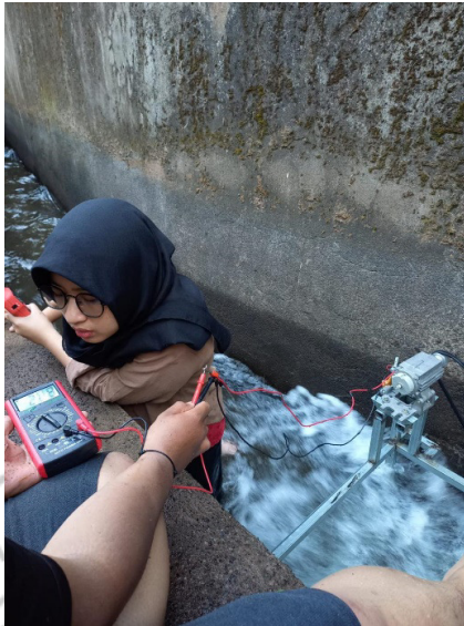
Pengukuran arus dan tegangan generator
