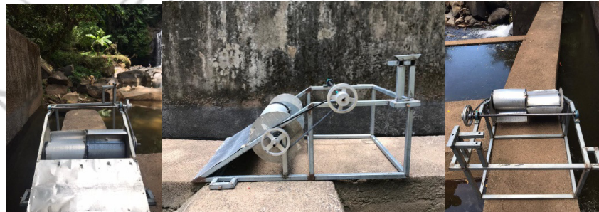
Gambar 4. 4 Hasil konstruksi untuk rotor savonius bawah air seri dengan sumbu horizontal
