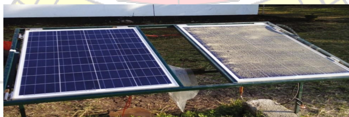
Gambar 2.13 Modul PV yang Tidak Terkena Debu dan Solar PV yang Terkena Debu.
