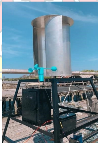
Gambar 2.3 Turbin angin tipe savonius pada penerangan rumah tambak sumber: Maudini dan Muh Amar Syarifuddin
