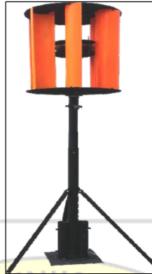
Gambar 2.2 Konstruksi Hasil Perakitan Kincir Angin dan Generator Magnet Permanen
