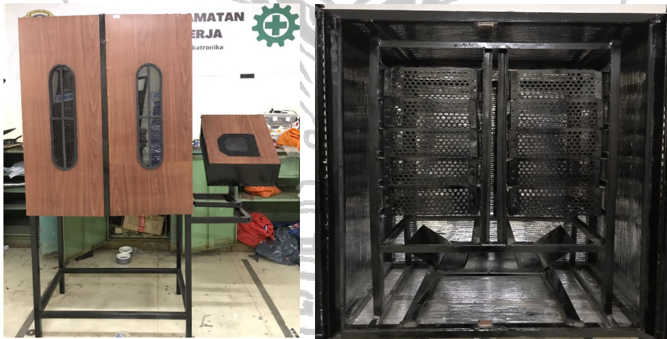
Gambar 4.1 Rancangan Mekanik Alat Pengering Rumput Laut
