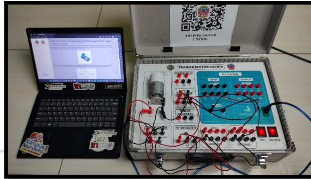
Gambar 4. 16 Uji Coba Pengukuran Tegangan
