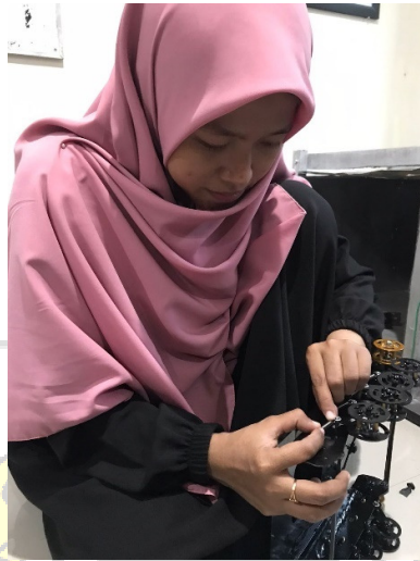
Pemasangan spring pada roda
