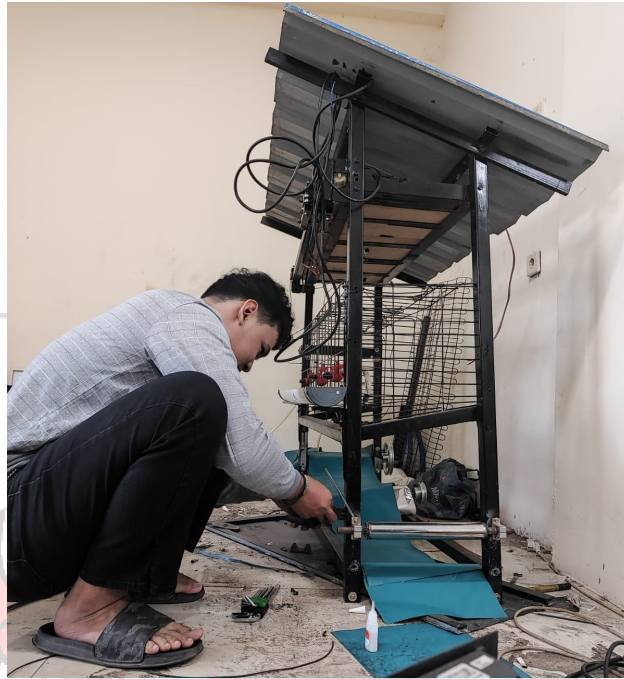
Proses Pengerjaan Belt Conveyor Pembersihan Kotoran
