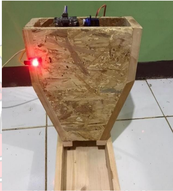
Gambar 2. 4 Hasil Perancangan Pemberi Pakan Ayam Otomatis (Sumber: Septianto, 2020)
