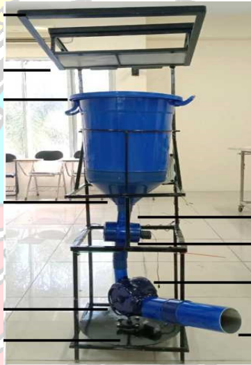
Gambar 2. 17 Robot Pelontar Pakan dan Pengukur Level Air Tahun 2022 (Sumber: Nurul Fitrianiingsi Judda dan A.Nur Hikmah, 2021)
