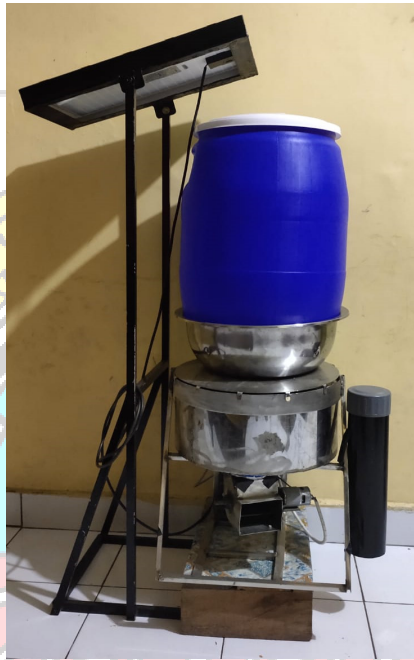
Gambar 2. 16 Robot Pelontar Pakan dan Pengukur Level Air Tahun 2022 (Sumber: Nurul Fitrianiingsi Judda dan A.Nur Hikmah, 2021)
