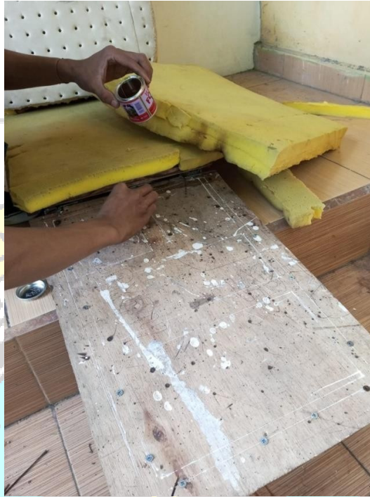
Pemasangan busa latex dan PU
