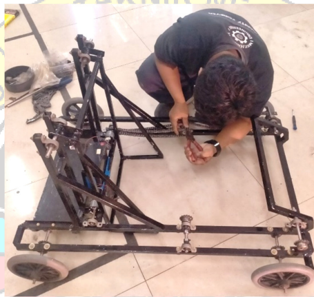
Gambar 4. 3 Proses Pemasangan Sproket dan Rantai
