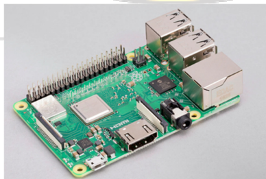
Gambar 2. 3 Raspberry Pi 3B+ (Sumber : Adafruit.com)
