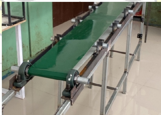
Gambar 4. 4 Pemasangan Belt Conveyor
