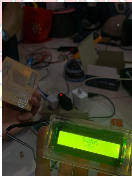
Pengetesan Pembacaan Sensor MPU 6050
