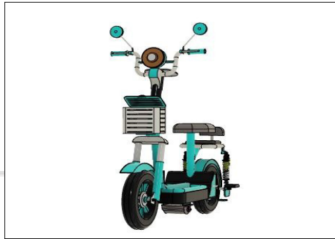
Gambar 4.4 Hasil Desain dan Animasi Sepeda Listrik Roda dua Menggunakan Sensor Gyroscope dan Aktuator Self Balancing Tampak depan menyamping
