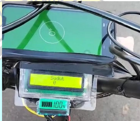
Gambar 4.11. Pengambilan Data Sudut Kemiringan
