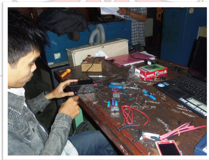
Pemasangan casing trafo
