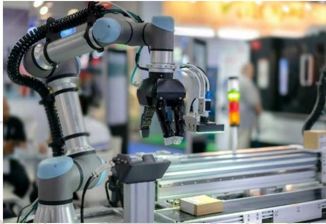
Gambar 2.11 End Effector sebagai Gripper (Sumber: Bernier, 2021)
