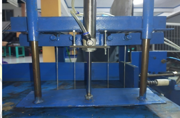
Gambar 4.7 Mekanisme pembersih kawat pemotong batu bata
