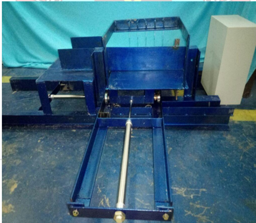
Gambar 2.16 Pemotong batu bata dengan aktuator pneumatik (Sumber : Umudiyah dan Achmad Waris Amir, 2017)
