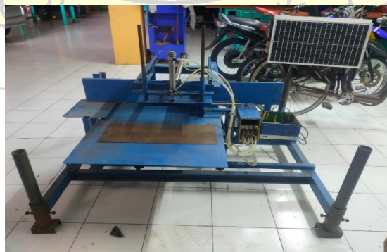
Gambar 2.18 Mesin pemotong batu bata otomatis dengan aktuator pneumatik (Sumber : Muhammad. dkk, 2018)
