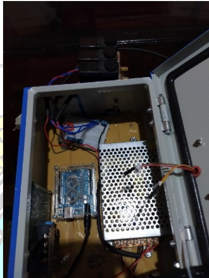
Gambar 4.13 Tata letak komponen elektronik pada cover box
