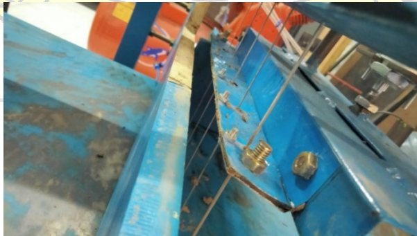
Gambar 4.19 Pembersih kawat pemotong yang siap dioperasikan
