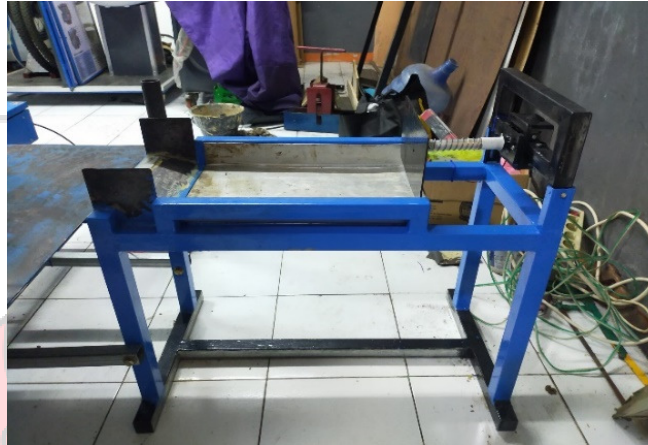
Gambar 4.11 Rangka penopang wadah yang telah terpasang
