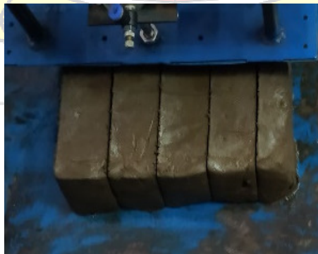
Gambar 4.18 Contoh hasil pemotongan adonan batu bata
