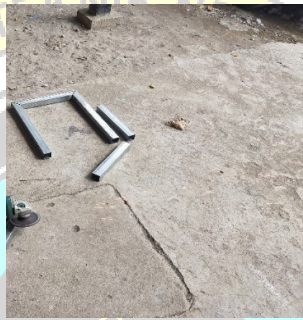
Gambar 4.9 Hasil pemotongan besi hollow untuk kaki rangka
