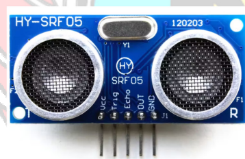
Gambar 2.4 Sensor Ultrasonic dan cara kerjanya
