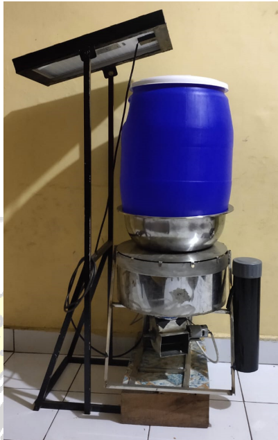
Gambar 2.20 Robot Pelontar Pakan dan Pengatur Level Air Tahun 2021 (Sumber: Muslimah Widyaningrum dan Gusti Rangga, 2021)
