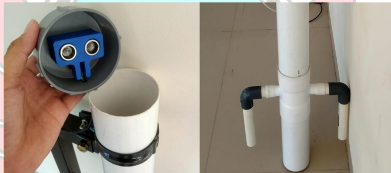
Gambar 4.2 Penempatan Sensor Jarak, Sensor Suhu, dan Sensor pH
