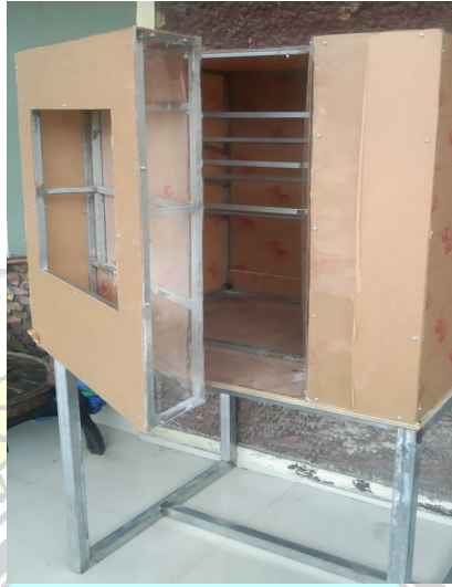
Gambar 4. 2 Proses Pemasangan Akrilik
