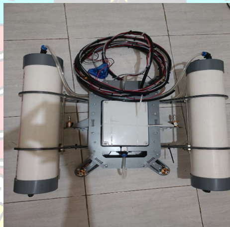
Gambar 4.2 Robot Bawah Air Berbasis Ballast
