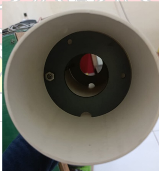
Gambar 4.13 Penambahan Sekat Penahan Air Ballast
