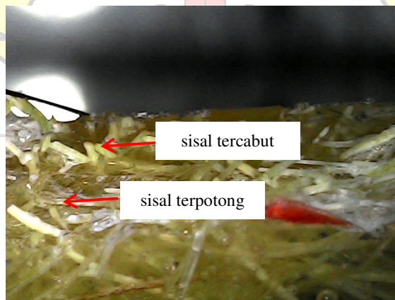
Gambar 4.22 Struktur makro komposit S15I0
