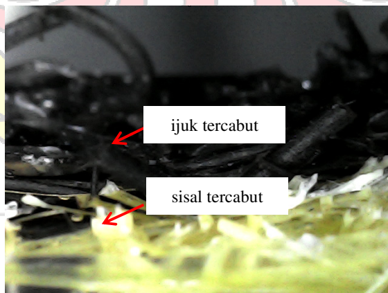
Gambar 4.25 Struktur makro komposit S7.5I7.5
