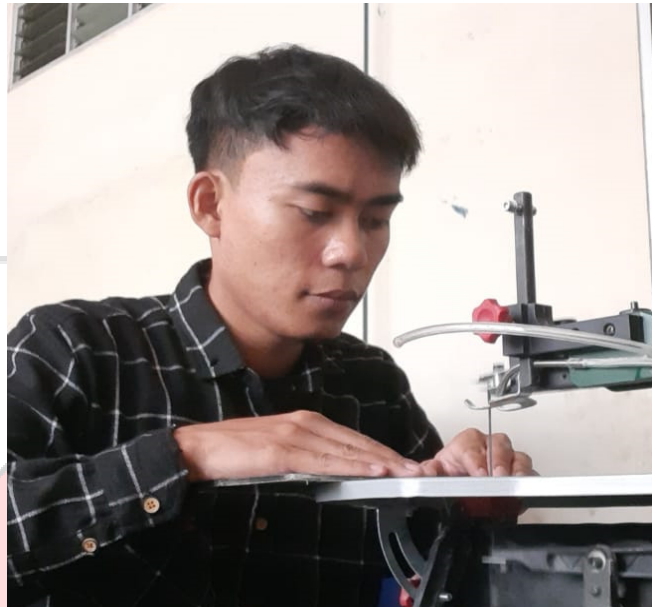
Memotong panel komposit menjadi sampel uji
