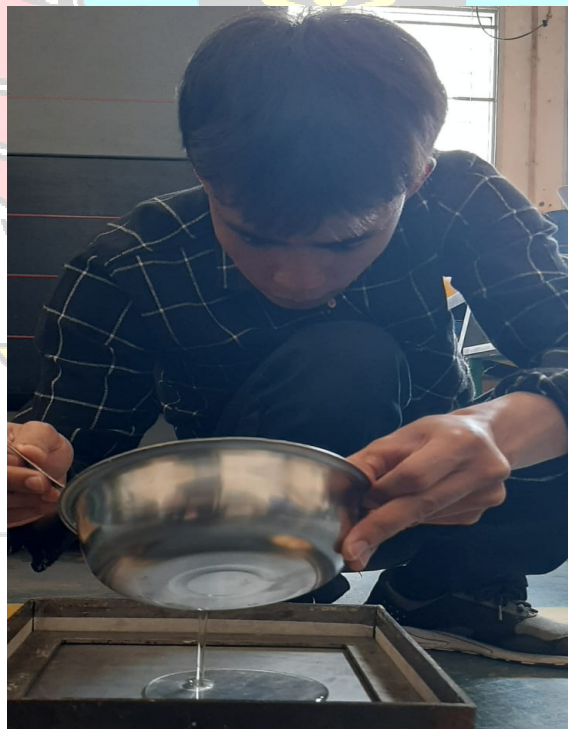
Penuangan matriks kedalam cetakan
