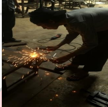
Proses pemotongan siku
