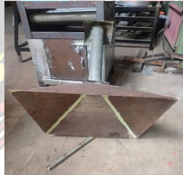
Proses pembuatan cerobong atas dan penutup tungku
