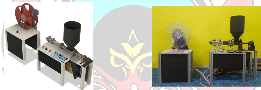
(a) Desain mesin ekstrusi filamen 3D Printer (b) Mesin ekstrusi filamen 3D Printer
