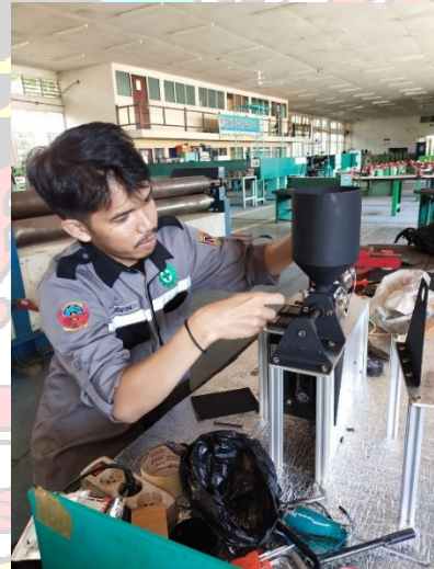
Proses Pemasangan hopper
