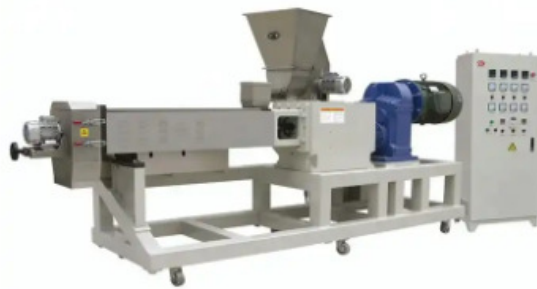
Gambar 2.9 Mesin Ekstruder (Sumber: https://images.app.goo.gl/ )
