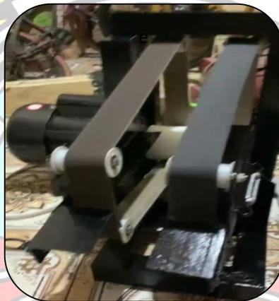
Gambar 4. 1 Hasil Pembuatan Mesin Gerinda Sabuk
