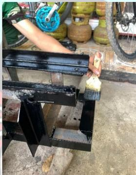
Gambar 3. 5 Tahap Pengecatan Rangka
