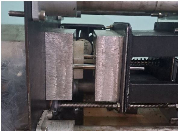
Mold Terisi Material LDPE
