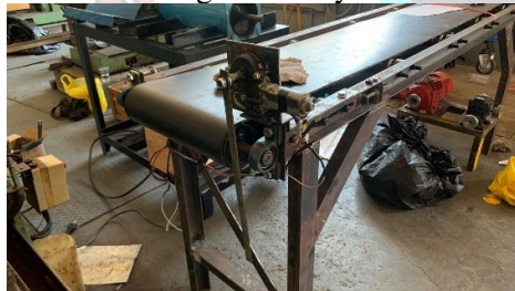
Mesin pemotong pada rangka konveyor
