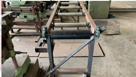
Pemasangan head pulley pada rangka konveyor
