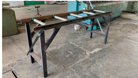
Rangka konveyor yang telah dipasangi roller
