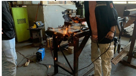
Pemasangan alat pemotong pada rangka konveyor
