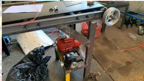
Posisi dinamo motor, gearbox dan pulley pada rangka konveyor
