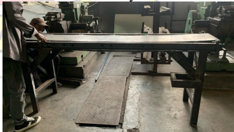
Menyesuaikan ukuran belt pada ukuran rangka konveyor
