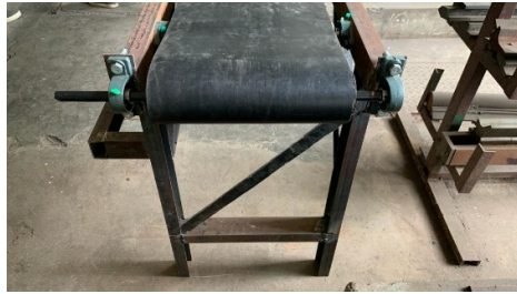
Penyesuaian belt dengan head pulley agar tidak terjadi pergeseran posisi pada belt
