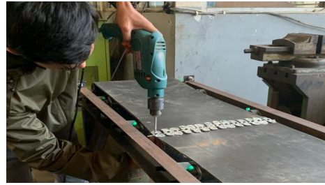
Penyambungan belt sesuai dengan ukuran yang telah disesuaikan
