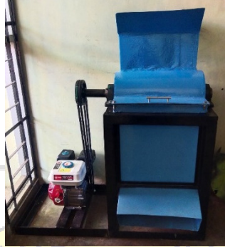
Gambar 4. 5 Spesifikasi Mesin Penghancur ( Crusher ) Arang Tempurung Kelapa
