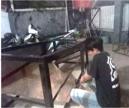
Proses perakitan rangka
