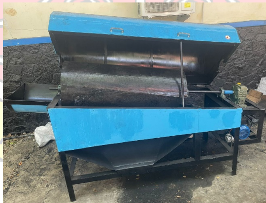
Gambar 3. 3 Hasil Perakitan Mesin Pengayak Arang Tempurung Kelapa
