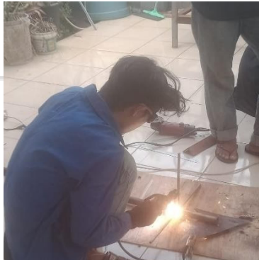
Proses pengelasan komponen pengayak
