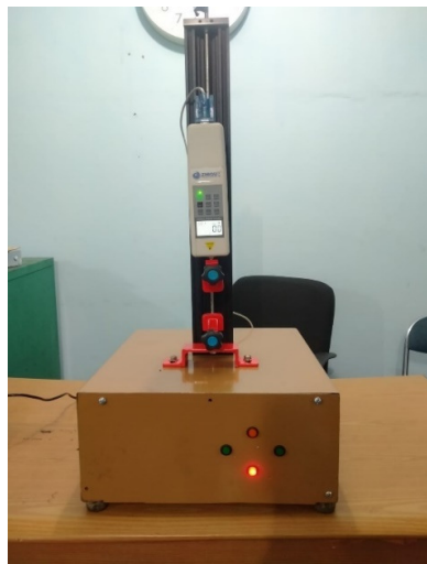
Gambar 4.1 Hasil Pembuatan Alat Uji Tarik Digital
