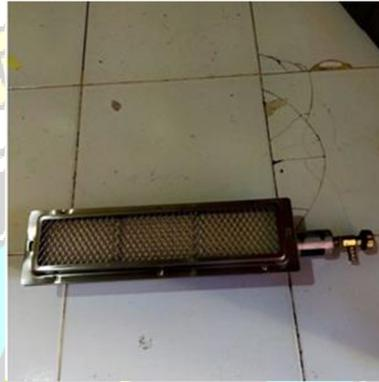
*Gambar 2.4 kompor infrared*
