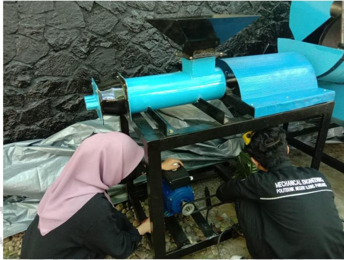
(proses *assembly* motor penggerak)
