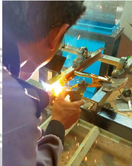
(proses *assembly* rangka ke wadah) (proses pengelasanudukan *bearing*)
