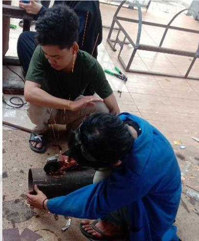
(Proses pembuatan lubang pipa)
