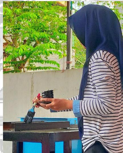
(proses pengecatan rangka)
