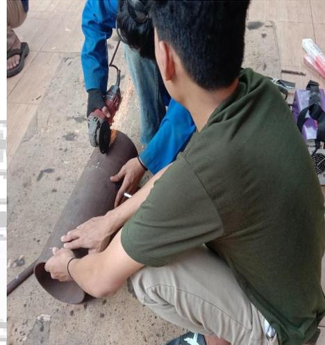
(Proses pembuatan lubang pipa)
