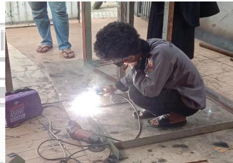
(Proses Pengelasan Rangka Mesin)
