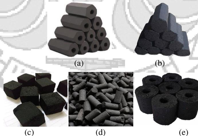
Gambar 6 Bentuk-bentuk Briket: (a) Briket Bentuk *Hexagon* Berongga Briket Bentuk Hexagon (c) Briket Bentuk Persegi (d) Briket Bentuk Silinder (e) Briket Bentuk Silinder Berongga.
