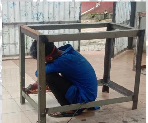
(Proses Pengelasan Rangka Mesin)
