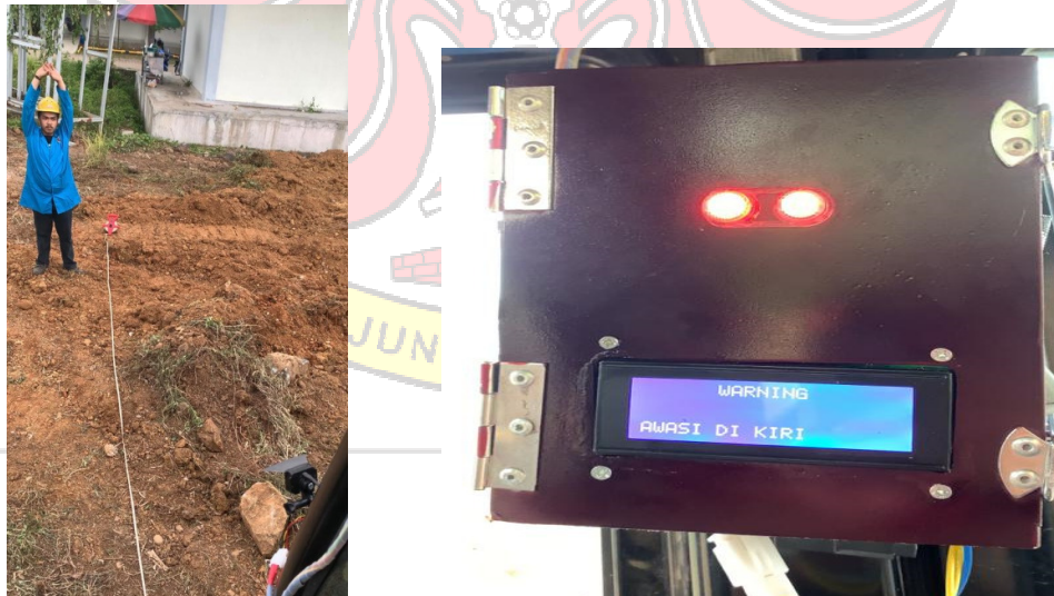
Gambar 4.4 Pengujian pada sensor sebelah kiri unit
