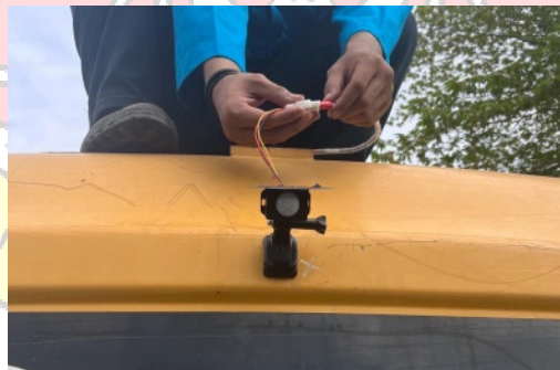
Gambar 3.14 pemasangan konektor pada pir sensor
