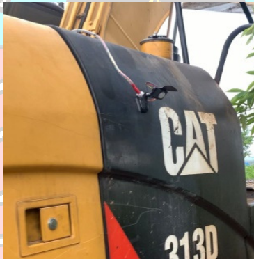
Gambar 3.10 peletakan sensor pada pintu hidrolik
