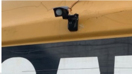
Gambar 3.12 peletakan sensor pada counterweight
