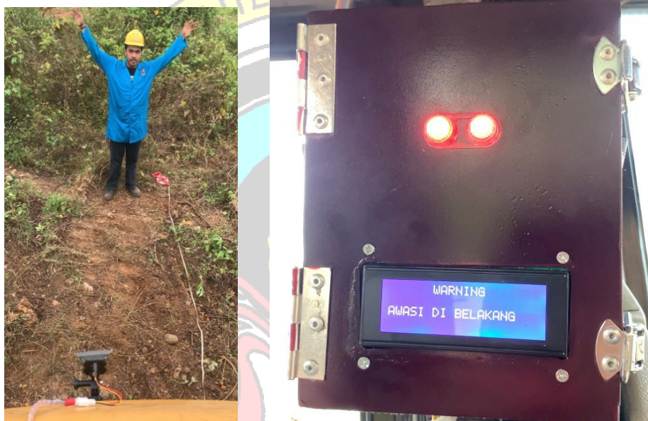
Gambar 4.5 Pengujian pada sensor belakang unit
