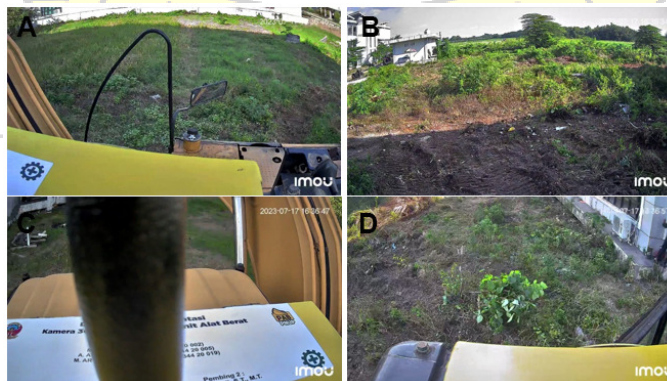
Gambar 42 Tampilan kamera 360 pada excavator dari 4 sudut
