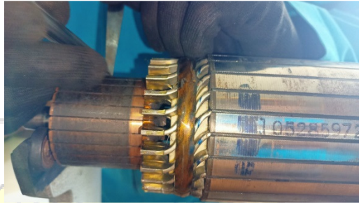
Gambar 4.17 Pengukuran kedalaman isolasi
