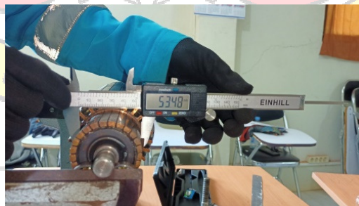
Gambar 4.16 Pengukuran diameter luar komutator
