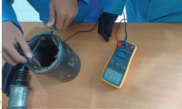
Gambar 4.12 Pengujian kumparan stator
