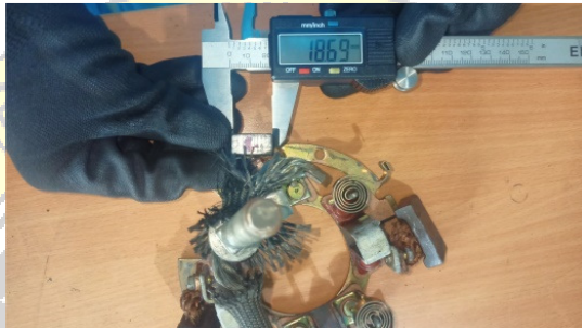
Gambar 4.18 Pengukuran panjang brush
