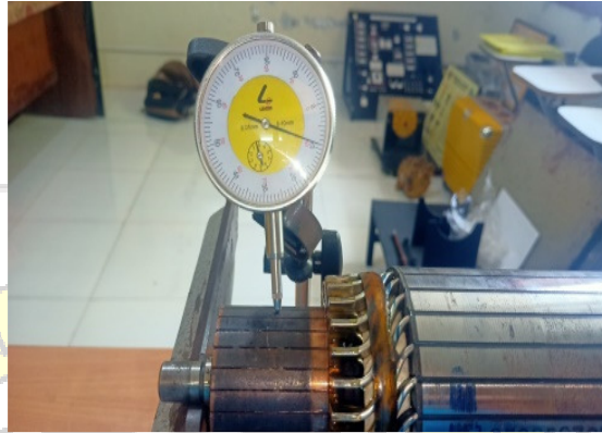
Gambar 4.27 Pengujian run-out komutator
