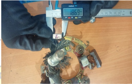
Gambar 4. 29 pengujian panjang brush
