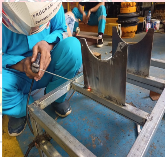
Gambar 3. 7 Pengelasan dudukan komponen ke rangka utama
