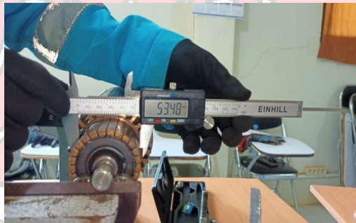
Gambar 4.28 Pengukuran diameter sisi luar komutator
